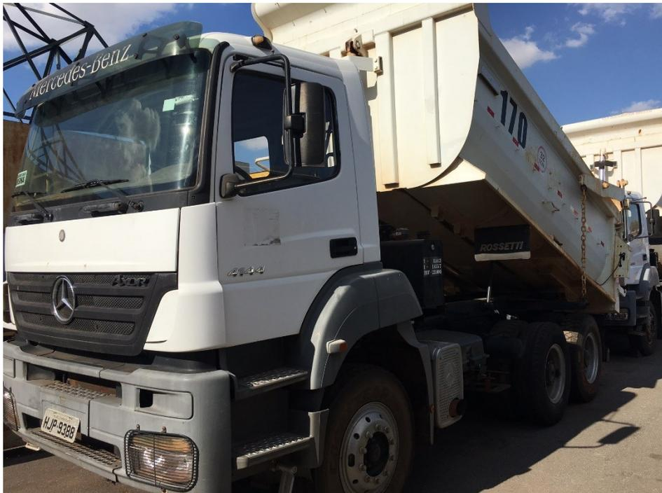
Caçamba elevada com o suporte de sustentação do cilindro original. É necessário abaixar a caçamba para realizar qualquer tipo de manobra.
