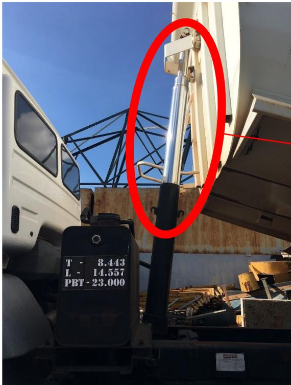
Haste do cilindro totalmente exposta ao ar livre, sujeita a corrosões.
