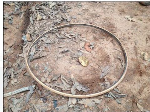
ANEL DE TRAVAMENTO, QUE SE DESPRENDEU DO PNEU.
