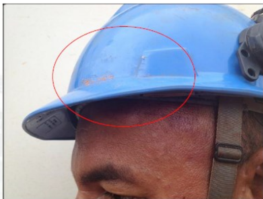
CAPACETE ATINGIDO PELO ANEL DE TRAVAMENTO DO PNEU.
