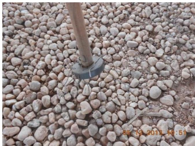
**Situação depois da Boa Prática:** Com a implantação da melhoria a área permaneceu mais limpa houve redução do risco de acidentes pois o dispositivo coleta os arames, pregos e outros materiais metálicos que poderiam causar perfuração ou lesões.
