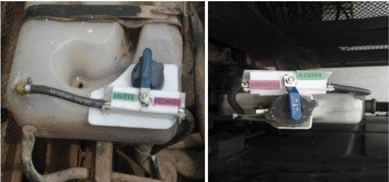
**Situação antes da Boa Prática:** O radiador não possuía o sistema de alívio de pressão interna, gerando risco de queimadura ao operador por água/vapor aquecido quando da retirada da tampa.
