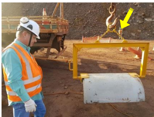
FIGURA 1 – TRAPESON. Suporte em uso, suportando a peça.
