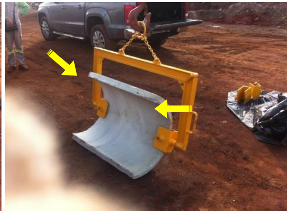
FIGURA 3 – ARTICULAÇÕES Lateral e garras articuladas para permitir o ajuste no carregamento e posicionamento das peças conforme necessário tanto para movimentação quanto ajuste na posição correta no ponto de uso/aplicação.
