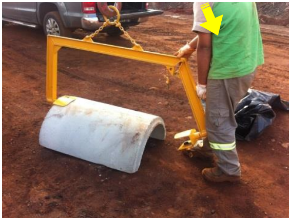
FIGURA 3 – ARTICULAÇÕES Lateral e garras articuladas para permitir o ajuste no carregamento e posicionamento das peças conforme necessário tanto para movimentação quanto ajuste na posição correta no ponto de uso/aplicação.
